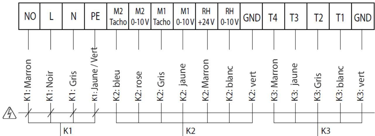
K1: Câble de raccordement pour moteurs M1, M2 et actionneurs Y1, Y2.
