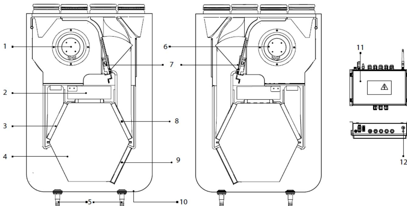
1 — Ventilateur d'extraction, 2 — Unité de contrôle (Version non Connect), 3 — Filtre sur air d'admission, 4 — Échangeur à contre courant, 5 — Tuyau des condensats, 6 — Ventilateur d'insufflation, 7 — Registre bypass, 8 — Filtre sur air extrait, 9 — Filtre optionnel sur air d'admission, 10 — Bac de récupération, 11 — Unité de contrôle externe (Version Connect) 12 — Bouton de configuration
