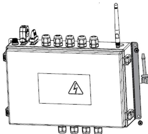
La conception des charnières permet de changer le côté d'ouverture d'un couvercle d'unité de commande. Dévissez les vis de fixation, ouvrez le couvercle et détachez-le. Réparer le couvercle aux charnières opposées, serrez les vis de fixation.
