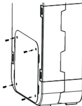
La plaque opposée au côté maintenance doit être fixée avec des vis (incluses dans le kit de livraison) avant l'installation.
