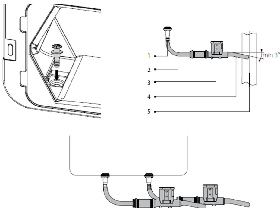
1 - flexible de vidange; 2 et 4 – tuyau d'évacuation; 3 - piège en U; 5 - Egouts.
