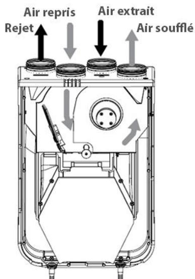
**Protection contre le gel** Un risque de gel apparaît lorsque la température de l'air d'échappement en aval de l'échangeur de chaleur est inférieure à +5 °C et la température de l'air d'admission en amont de l'échangeur de chaleur est inférieure à -3 °C pour les unités avec préchauffage, et à l'échappement en aval de l'échangeur de chaleur si la température est inférieure à +3 °C pour les unités sans préchauffage.
