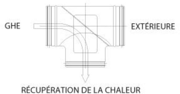
Les valeurs Température extérieure de l'échangeur de chaleur géothermique inférieure (#193) et Température extérieure de l'échangeur de chaleur géothermique supérieure (#194) sont définies en mode par défaut pour 5°C et 25°C. Ils peuvent être modifiés à partir de l'outil de service et du contrôleur d'affichage LCD.
