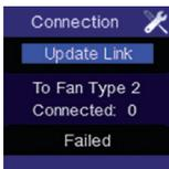
– Si le lien n'est pas réalisé, l'écran suivant apparaît : Recommencez la procédure en cas de mention "failed".
