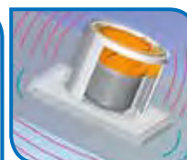
Un aérateur traditionnel transmet les vibrations
